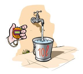
Wird in Kubikmetern pro Stunde (m3/h) angegeben und ist in den Unterlagen Ihres örtlichen Wasserwerks zu finden. Zur Sicherheit sollten Sie sie jedoch selbst nachprüfen: Füllen Sie einen 10-Liter-Wassereimer an dem Wasserhahn, der am nächsten zum Wasserzähler liegt, und prüfen Sie, wie lange es dauert, den Eimer zu füllen (in Sekunden).
